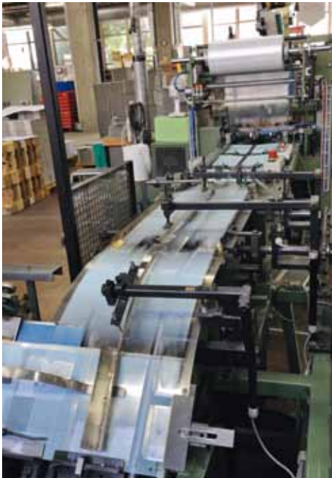
Fertigungslinie für Register inkl. Verpackung.
