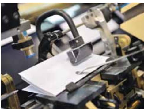
Vollautomatische Maschine für die Herstellung von Planern mit Registerschnitt.
