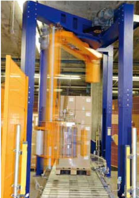
Stretcher mit drei verschiedenen Warenzugängen für Paletten.
